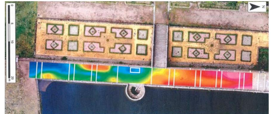
[Fig. 7]. Estudio de gravimetría y tomografía del dique. Universidad de Salamanca 2021
